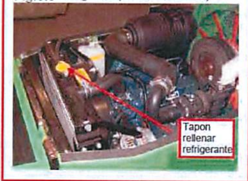
Fig. 6.3 Refrigerante (solo motores diesel)
